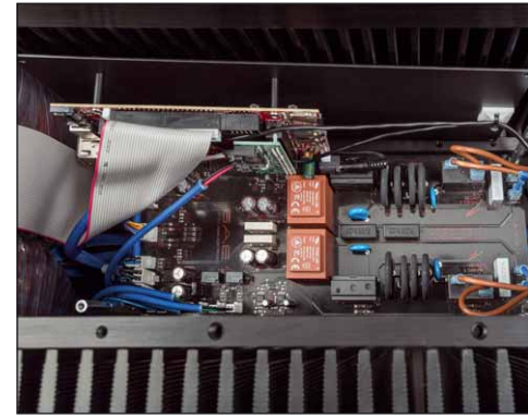
Die Platine in der Mitte kümmert sich ums sanfte Einschalten und die „Gesundheit“ der Lautsprecher
