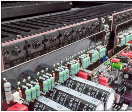
Viermal sieben Leistungstransistoren bilden die gebrückte Endstufenkonfiguration pro Kanal
